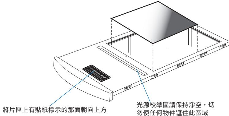
2. 將防漏玻璃片匣置入位於掃描器下層的掃描平台內，推到定位。
