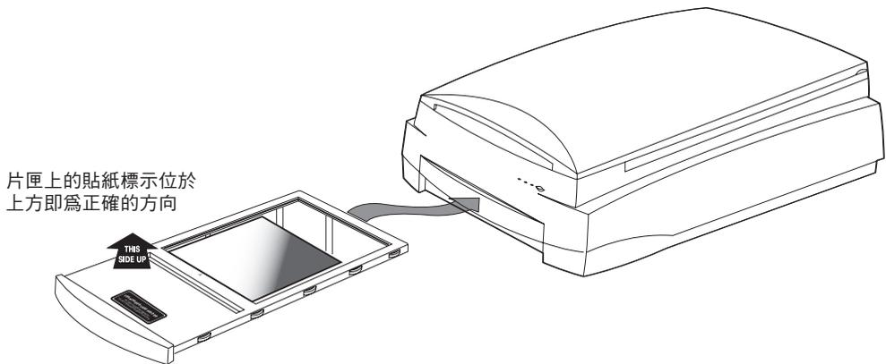
請注意，當掃描電泳膠片或正片時，如有必要時，請使用掃描器配件中所附的靜電貼紙來固定稿件，再將整個組合置入位於掃描器下方的透射稿掃描平台內。確認防漏玻璃片匣置放的方向正確無誤。
